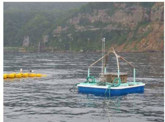
図2 函館市古部地区に設置したリモート魚群探知機
