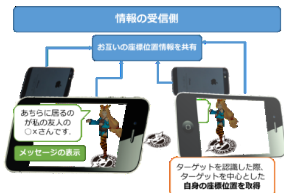
図2 情報受信側のシステム概要
